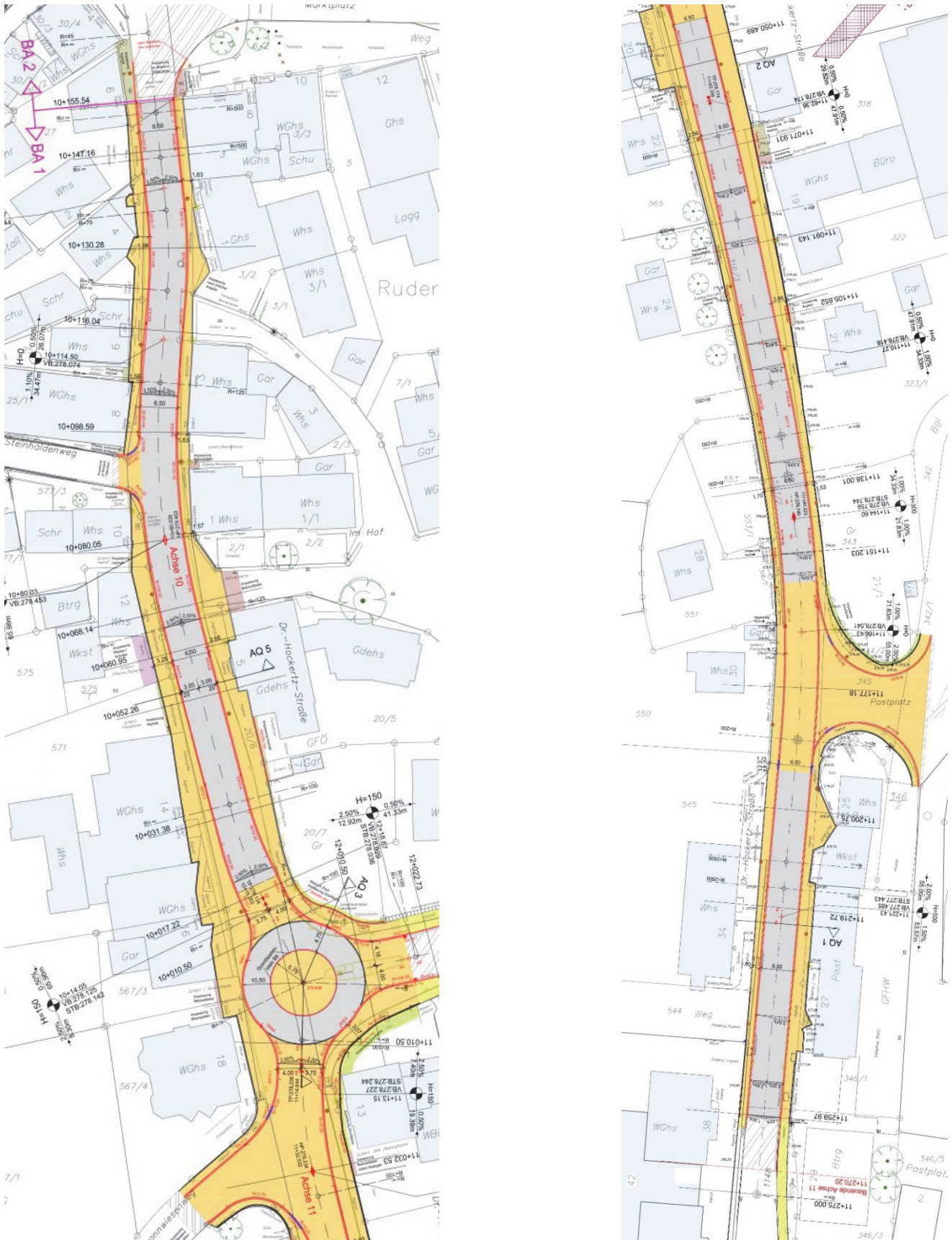
Bild 8 | Der Umgestaltungsentwurf für den mittleren (links) und südlichen (rechts) Abschnitt im Lageplan: Trennungsprinzip für Fahrbahn und Gehwege, Teilaufpflasterungen im Bereich der Einmündungen von Seitenstraßen, in den Zufahrten des Minikreisels am Schnittpunkt der beiden Landesstraßen und in der Bahnhofszufahrt (siehe „Postplatz“ im rechten Plan)
