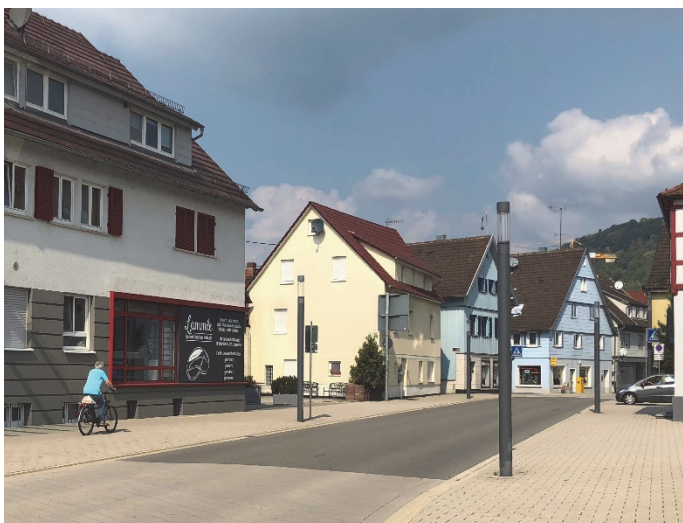
Bilder 30 und 31 | Seitenraum: wechselnde Baufluchtabstände führen zu unterschiedlichen Gehwegbreiten, die jedoch an keiner Stelle das Mindestmaß nach Regelwerk unterschreiten, die gepflasterte „Gehwegüberfahrt“ (linker Gehweg im rechten Bild) betont den Vorrang für Zufußgehende über die Einmündung der Seitenstraße hinweg, der Fußgängerüberweg betont zugleich den Beginn der Ortsmitte
