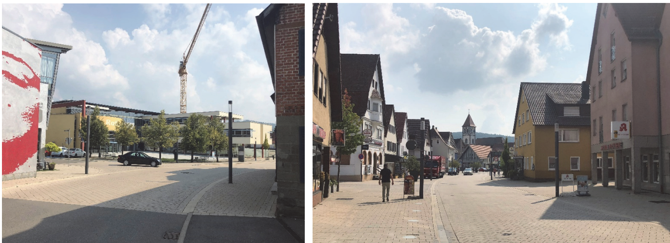
Bilder 12 und 13 | Fahrbahngestaltung: wahrnehmbarer Beginn der Ortsmitte, die anthrazite Farbgebung der dicht gesetzten Beleuchtungsmasten unterstützt wirksam den Verlauf des Sonderbordes, der Fahrbahn und Seitenräume „weich“ trennt
