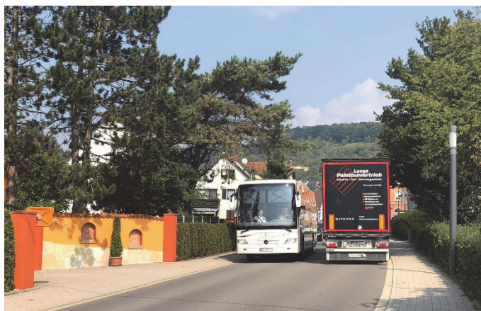
Bilder 28 und 29 | Gestaltungsgrundsatz Trennungsprinzip: die Fahrbahn lässt Begegnungen im Schwerverkehr bei der angeordneten Geschwindigkeit von 30 km/h uneingeschränkt zu, die unterbrochene Leitlinie (linkes Bild) endet vor der ersten gepflasterten Einmündung und wird dahinter (rechtes Bild) nicht weitergeführt
