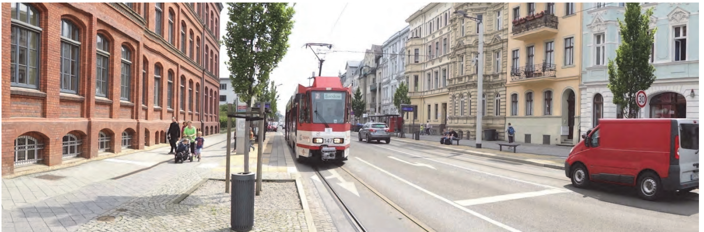
Bild 16 | Klare Gliederung und Kenntlichmachung der Flächen für die einzelnen Verkehrsarten: Durchgängige Plattenbeläge für Gehbahn und Radweg; Verbesserung der Aufenthaltsqualität: Zwischen Parken und ÖPNV-Haltestellen mit Bänken und Fahrradabstellbügeln
