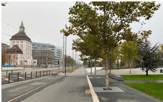
Bilder 14 und 15 | Führung des Fuß- und Radverkehrs: in Bild 14 erkennbar mindestens 4,50 m breiter, gemeinsam genutzte Verkehrsfläche für Zufußgehende und Radfahrende; abweichend von der Beschilderung als „Gemeinsamer Geh- und Radweg“ gilt parallel zur Straßenbahnhaltestelle für aus nördlicher Richtung kommende Radfahrende „Gehweg, Radfahrer frei“ (Bild 15)
