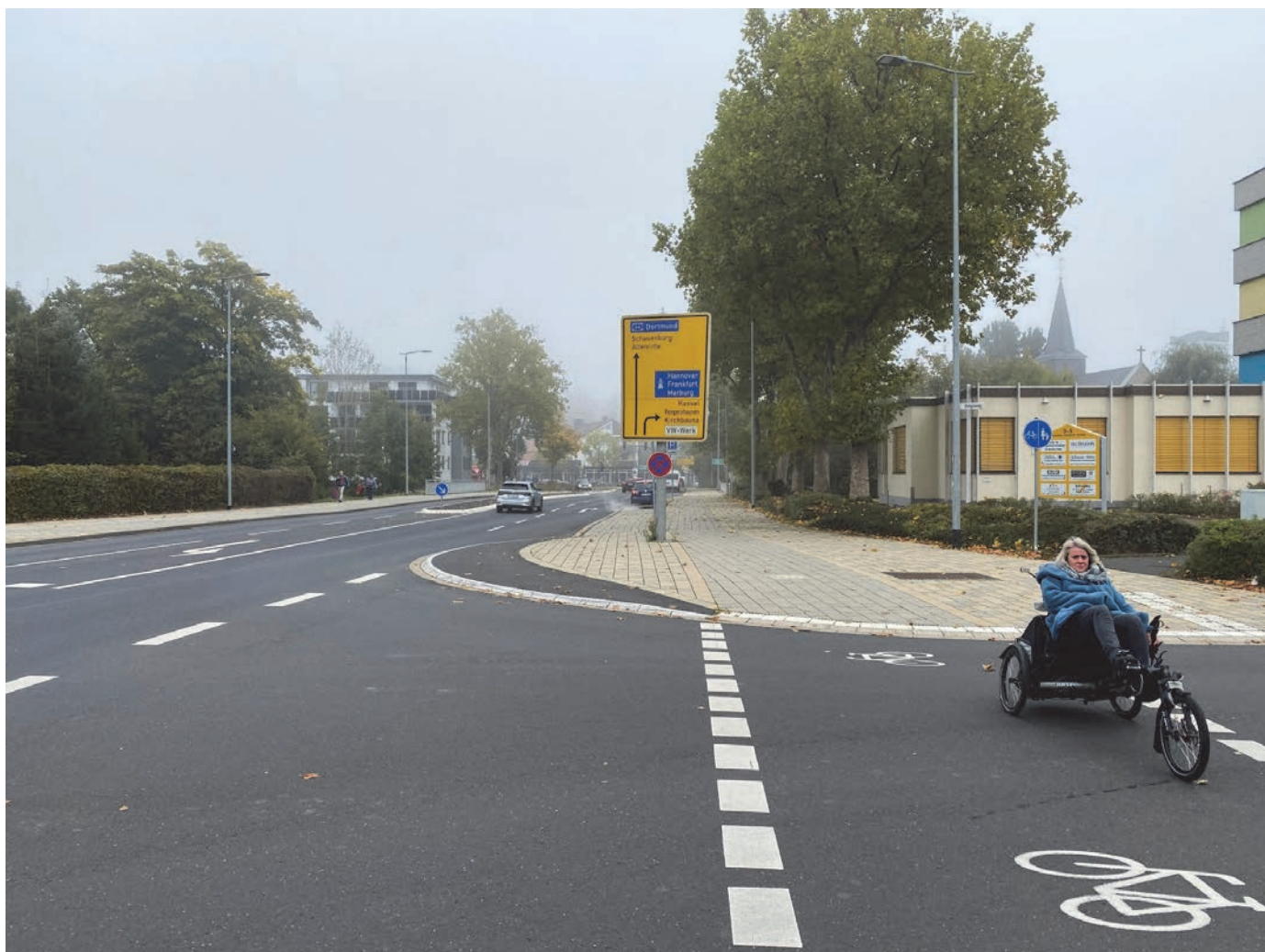
Bild 23 | Gestaltungsdetail: Die im Seitenraum asphaltierte, „selten befahrene Fläche“ in der Ausfahrt aus dem Bingeweg in die Heinrich-Nordhoff-Straße ist auf Grundlage der Schleppkurven von Schwerverkehrsfahrzeugen konstruiert und dient nicht zuletzt dazu, dass der Linksabbiegestreifen in der Hauptverkehrsstraße nicht zurückgezogen markiert werden musste.
