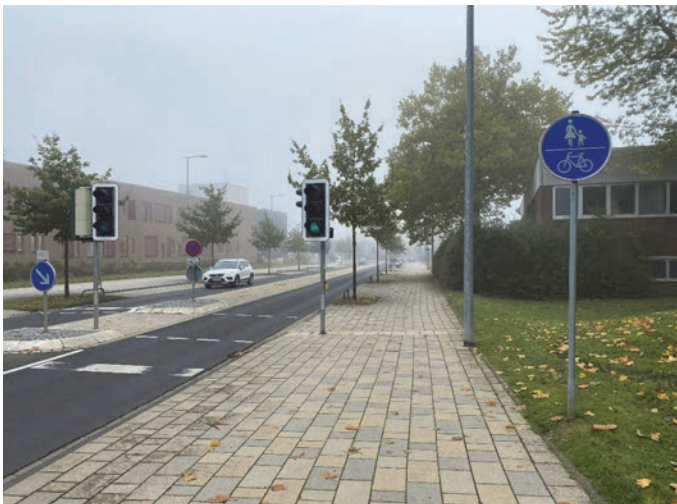
Bilder 26 und 27 | Radverkehrsführung im Übergang zum Bestand: aus Westen kommend zunächst gemeinsamer Geh- und Radweg (links), im Zulauf zum zentralen Kreisverkehrsplatz dann Trennung von Rad- und Gehweg mit Piktogramm-Platte (rechts)
