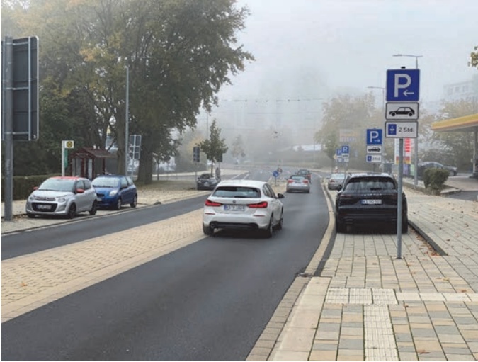
Bilder 46 bis 48 | Parkstände im Straßenraum: überwiegend Längsaufstellung (oben links), bei breiteren Baufluchtabständen auch Schrägaufstellung (oben rechts), die gewählte Breite von 2,25 m begünstigt offenbar ein geordnetes Abstellen der Fahrzeuge (rechts)
