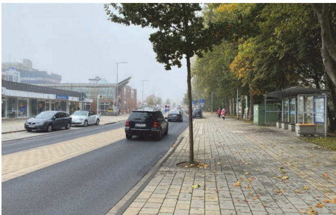
Bilder 44 und 45 | Gestaltung der Bushaltestellen: Ein- und Ausstiegsbereich mit Leitindikatoren und erhöhtem Kapbordstein, durchlaufender Radweg und Gehweg, rückwärtig angeordneter Witterungsschutz mit Sitzgelegenheiten für wartende Fahrgäste
