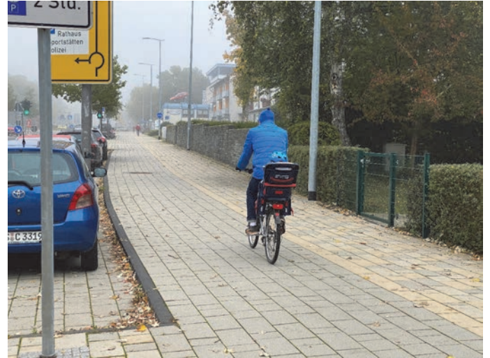
Bilder 24 und 25 | Radverkehrsanlagen: durchgängige Herstellung von 2 m breiten Radwegen im Seitenraum, neben Parkstreifen (rechtes Bild) sind darin 0,75 m als Sicherheitstrennstreifen enthalten, in Abschnitten ohne Parkstreifen (linkes Bild) verlaufen die Radwege von der Fahrbahn abgesetzt und ergeben damit Multifunktionsflächen für unterschiedliche Nutzungen
