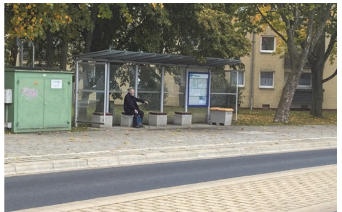
Bilder 44 und 45 | Gestaltung der Bushaltestellen: Ein- und Ausstiegsbereich mit Leitindikatoren und erhöhtem Kapbordstein, durchlaufender Radweg und Gehweg, rückwärtig angeordneter Witterungsschutz mit Sitzgelegenheiten für wartende Fahrgäste
