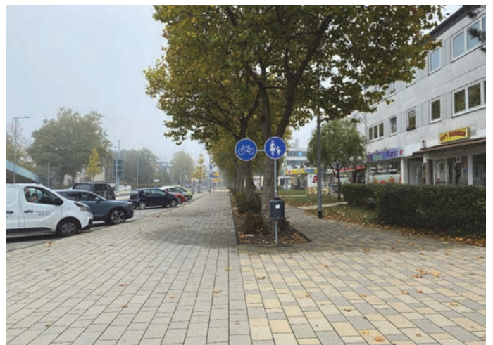
Bilder 29 und 30 | Gehwege im Streckenverlauf: durchgängig wird eine Breite von 2,50 m eingehalten, lediglich zur Bewahrung des vorhandenen Baumbestandes in der Heinrich-Nordhoff-Straße erfolgt eine Verringerung der Gehwegbreite auf 2,25 m
