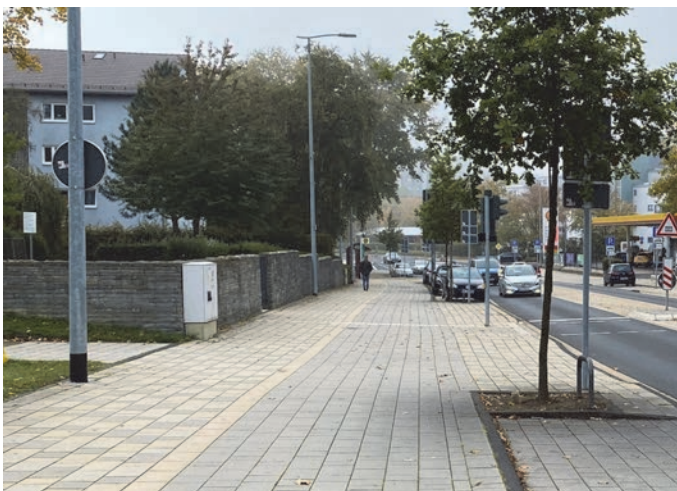
Bilder 29 und 30 | Gehwege im Streckenverlauf: durchgängig wird eine Breite von 2,50 m eingehalten, lediglich zur Bewahrung des vorhandenen Baumbestandes in der Heinrich-Nordhoff-Straße erfolgt eine Verringerung der Gehwegbreite auf 2,25 m
