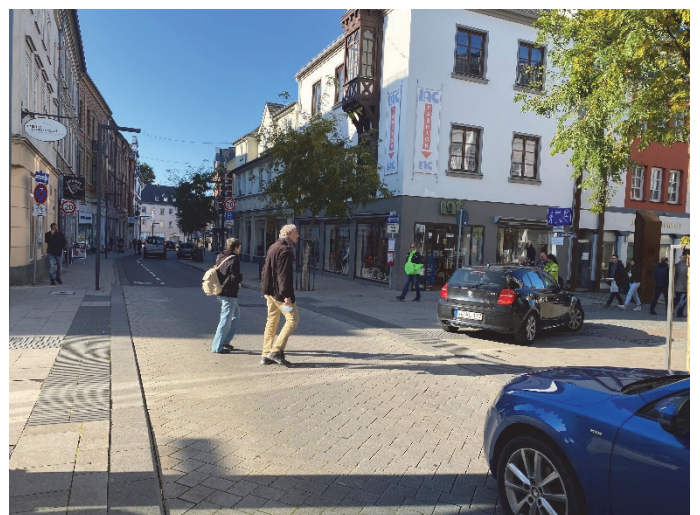
Bilder 19 bis 21 | Kreuzung von Grabenstraße und Bahnhofstraße: Shared Space-ähnliche Situation durch lange Teilaufpflasterung der Grabenstraße zur Verdeutlichung der quer verlaufenden Fußverkehrsachse zwischen Altstadt und Neumarkt, straßenverkehrsrechtlich nach Norden in Richtung Altstadt (Zentralperspektive von Bild 20, in Bild 21 rechts einmündend) als Verkehrsberuhigter Bereich, nach Süden in Richtung Neustadt/Neumarkt als Fußgängerbereich ausgewiesen
