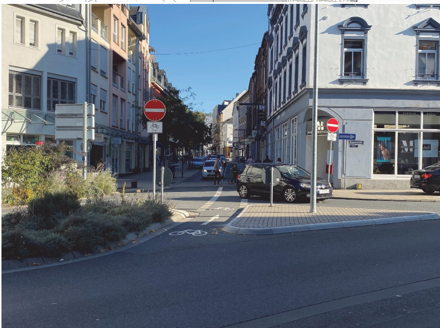
Bilder 10 und 11 | Einfahrsituation für Radfahrende in den westlichen Abschnitt: bauliche Radfahrerschleuse, durch einen begrünten Mittelstreifen und eine gepflasterte Dreiecksinsel (ohne Querungsfunktion im Fußverkehr) mit – angeschrägten – Flachbordsteinen gefasst, Übergang zum Schutzstreifen als Furt in Blockmarkierung ausgeführt
