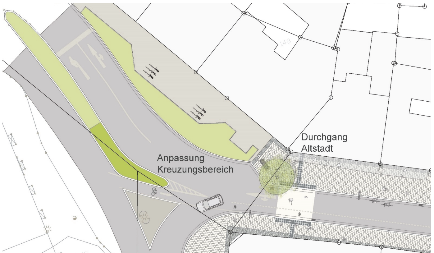
Bilder 10 und 11 | Einfahrsituation für Radfahrende in den westlichen Abschnitt: bauliche Radfahrerschleuse, durch einen begrünten Mittelstreifen und eine gepflasterte Dreiecksinsel (ohne Querungsfunktion im Fußverkehr) mit – angeschrägten – Flachbordsteinen gefasst, Übergang zum Schutzstreifen als Furt in Blockmarkierung ausgeführt
