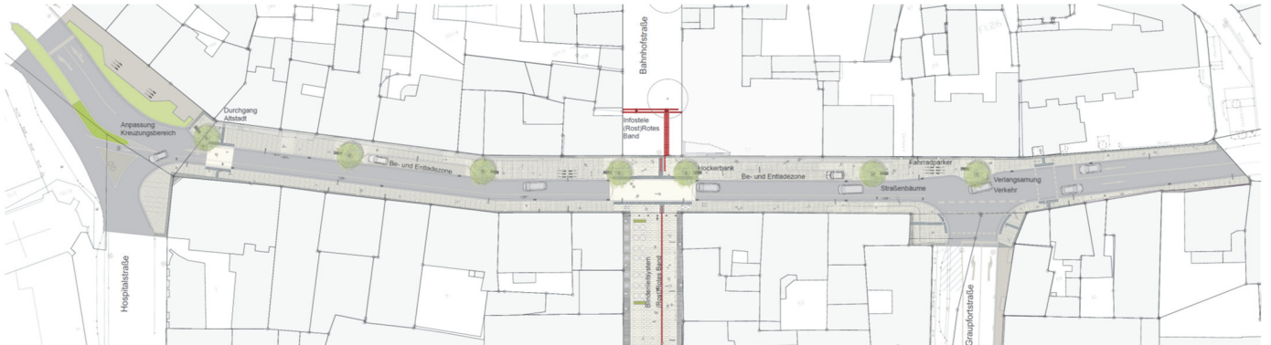
Bild 5 | Entwurfskonzept im Lageplan: schmale Fahrbahn im Einrichtungsverkehr, gegenläufiger Schutzstreifen für Radfahrende, altstadtseitig breiterer Seitenraum, baulich-gestalterische Priorisierung des Fußverkehrs im Zuge der querenden Bahnhofstraße, bauliche Sicherung und Betonung der Einfahrtsbereiche in den umgestalteten Abschnitt
