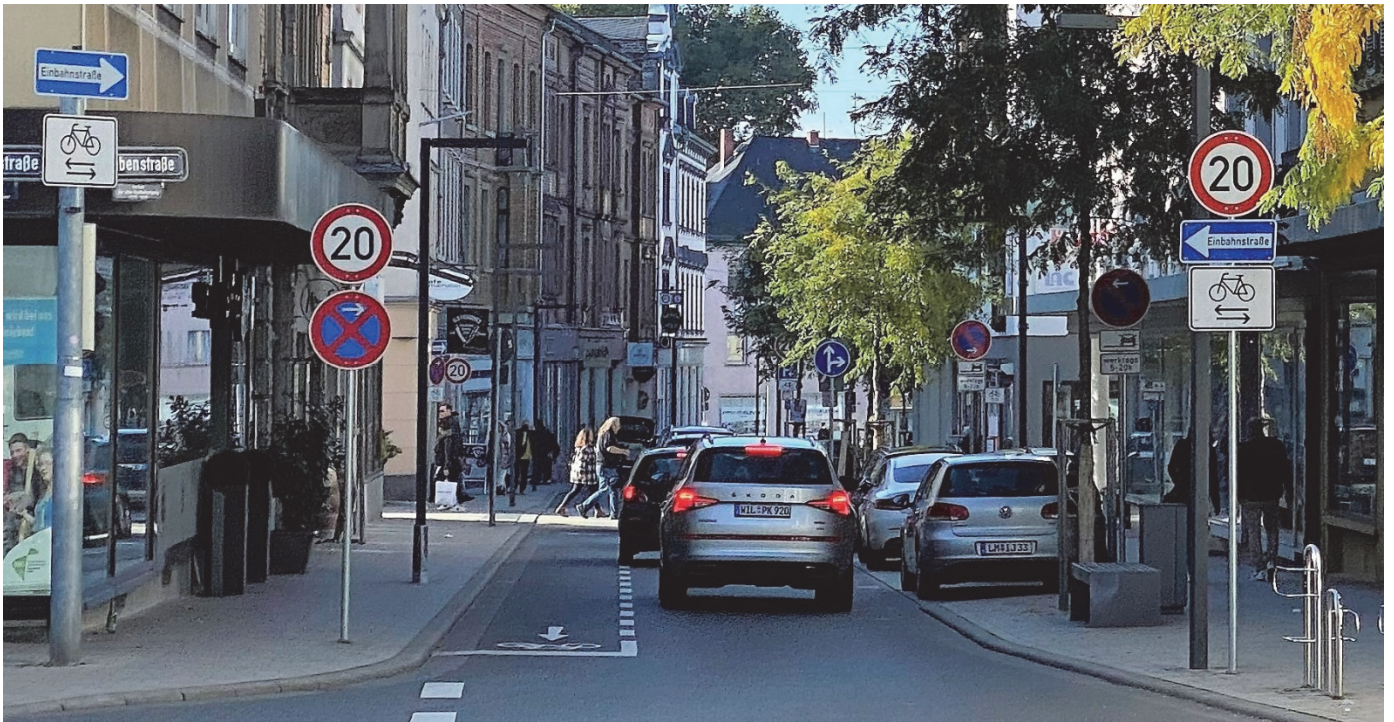
Bild 23 | Verkehrsregelungen: aufeinander abgestimmtes Set von Regelungen zur wirksamen Erhöhung des Komforts und der Verkehrssicherheit insbesondere im Fuß- und Radverkehr wie auch zur Sicherung des Kfz-Verkehrsflusses auf geringem Geschwindigkeitsniveau (Tempo 20), das dem Radverkehr angemessen ist
