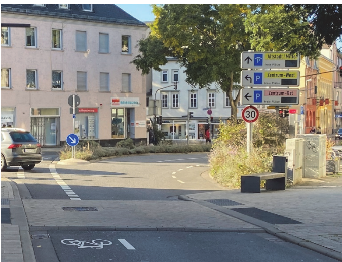
Bilder 25 und 26 | Bautechnische Details: nahezu auf Gehwegniveau angehobene Teilaufpflasterung mit Flachbordstein zur Asphaltfahrbahn hin, 2 cm-Kante zwischen Pflasterfläche und Gehweg auf nahezu gesamter Breite und Nullabsenkung für Rollstuhlfahrende in einem kurzen Teilbereich (in Bild 24 hinten sichtbar)
