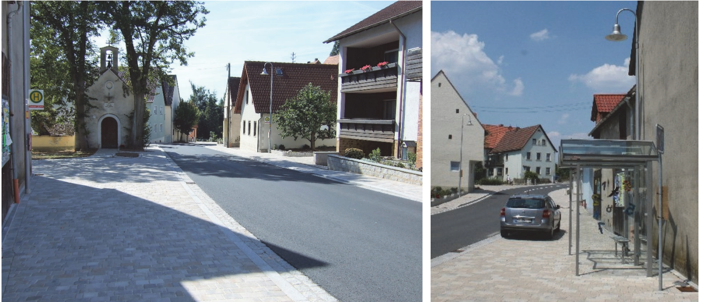
Bilder 30 und 31 | Zentrale Bushaltestelle: funktionale Mindestausstattung, transparenter Witterungsschutz und direkte Beleuchtung zur Erhöhung der sozialen Sicherheit bei Dunkelheit
