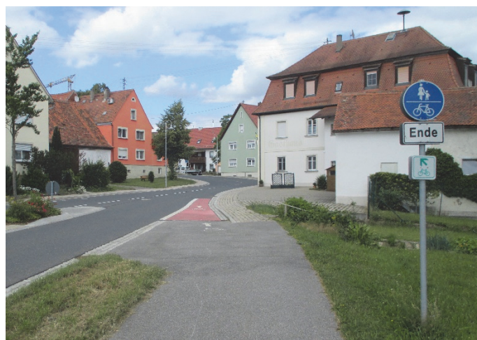
Bilder 9 und 10 | Ortseinfahrt: Verschwenkung des ortseinwärts gerichteten Fahrstreifens (siehe linkes Foto) zur Aufmerksamkeitserhöhung und Geschwindigkeitsreduzierung, Fahrbahnteiler mit Baum und niedriger Unterpflanzung zur Verortung des „Orts- eingangs“ und Überleitung in die Ortsdurchfahrt, der kurze Radfahrstreifen bringt Radfahrende sicher auf die Fahrbahn
