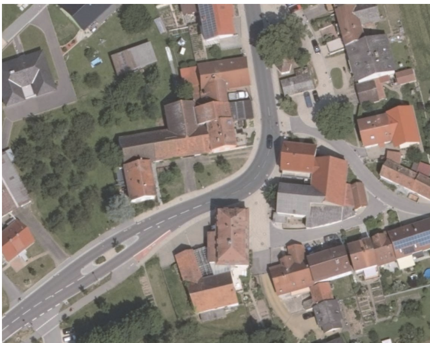
Bild 8 | Umgestaltete Ortsdurchfahrt im Luftbild: ortsangepasste Linienführung mit schmaler Fahrbahn und durchlaufenden Gehwegen, die auch über die einmündenden Nebenstraßen hinweggeführt werden
