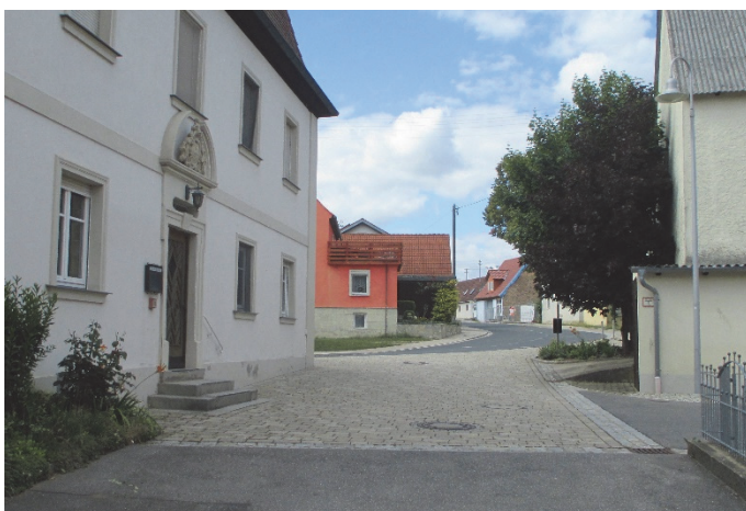
Bilder 23 bis 25 | Einmündungen: Pflasterflächen schaffen als „Gehwegüberfahrt“ zusammenhängende Gehwege, legen die Priorität von im Zuge der Ortsdurchfahrt Zufußgehenden gestalterisch nahe und stellen eine gestalterische Verbindung zu Nebenstraßen und -flächen her
