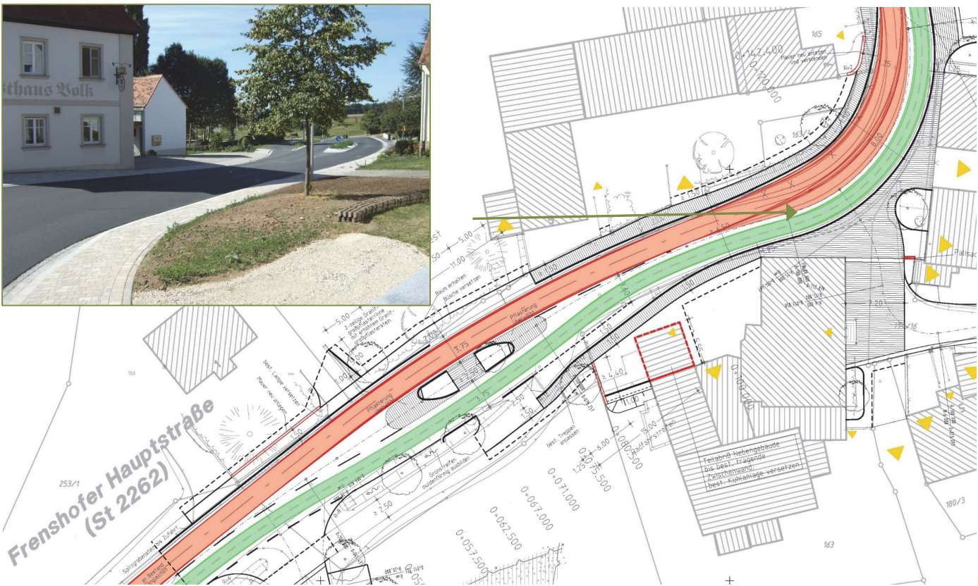
Bilder 17 und 18 | Fahrbahnaufweitungen und Linienführung: Trotz der schmalen Fahrbahnausführung ist eine gute Befahrbarkeit gesichert
