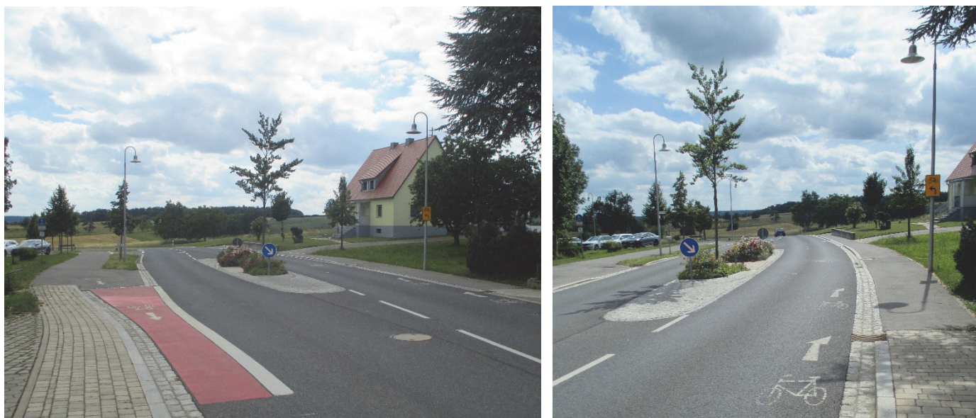
Bilder 14 und 15 | Radverkehrsführung am Ortseingang: kurzer Radfahrstreifen auf der Seite des in den Ort einmündenden, die Landstraße begleitenden Geh- und Radweges (linkes Bild); auf der gegenüber liegenden Seite zwar nicht StVO-gemäß, aber hilfreich und im Verkehrsalltag wirksam: Fahrbahnpiktogramme und ein Hinweisschild am Laternenmast zur Erläuterung des vorgesehenen Wechsels über den Fahrbahnteiler auf den Außerortsradweg für unsichere Radfahrende
