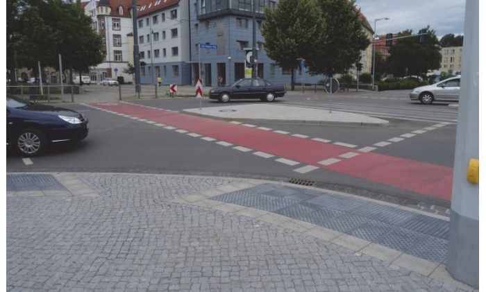
Bilder 14 und 15 | Verkehrsflächenaufteilung: deutliche Kennzeichnung und Eingrenzung der verschiedenen Verkehrsflächen für Stadtbahn, Kraftfahrzeugverkehr, Radverkehr und Fußverkehr durch Markierungen, Borde und unterschiedlichen Oberflächenbelag – in den Knotenpunkten zusätzlich unterstützt durch Fahrbahnteiler
