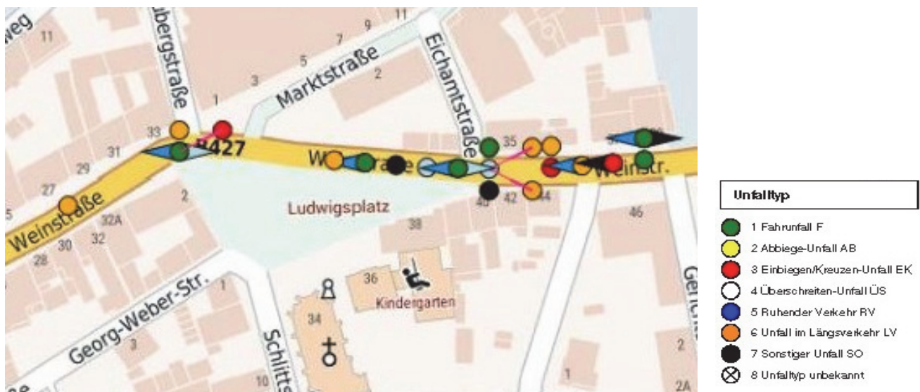
Bild 25 | EUSKa-Auszug zum Verkehrsunfallgeschehen nach der Umgestaltung in den Jahren 2014 bis 2018: 22 Verkehrsunfälle im 5-Jahres-Zeitraum, davon im Jahr 2014 zwei Unfälle mit leichtverletzten Pkw-Insassen und insgesamt keine Beteiligung von Zufußgehenden oder Radfahrenden
