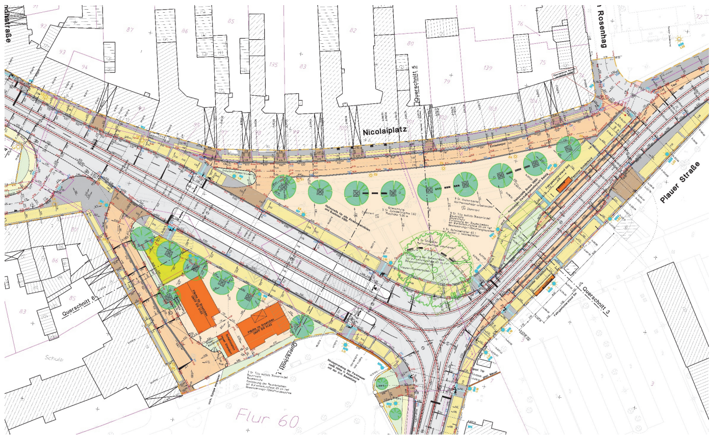
Bild 7 | Der neugestaltete Nicolaipplatz im Lageplan: Dreiarmer Knotenpunkt am Rand einer großzügig dimensionierten, zusammenhängenden Platzfläche, verbesserte Umsteigebeziehungen im ÖPNV, exponierte Lage der beiden Naturdenkmäler Platane und Säuleneiche – die Führung des Radverkehrs wurde im Rahmen der Ausführungsplanung geändert zu Mischverkehr auf der Fahrbahn bei 30 km/h sowie „Gehweg, Radfahrer frei“
