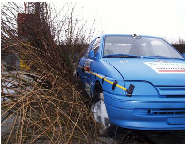
Abbildung 4: Seitlicher Anprall gegen ein Gebüsch (vK = 40 km/h) Foto: DEKRA / AXA Versicherungen AG
