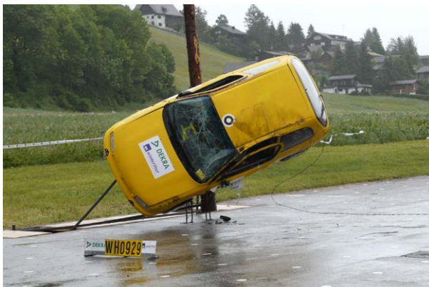
Abbildung 8: Crash mit Überschlag: Erstkontakt mit dem Fahrzeugboden (vK = 40 km/h) Foto: DEKRA / AXA Versicherungen AG
