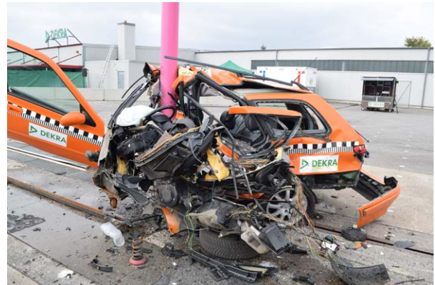
Abbildung 11: Seitlicher Pfahlanprall mit einem Peugeot im Jahr 2016 (vK = 100 km/h) Foto: DEKRA
