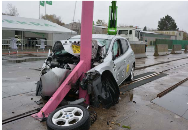
Abbildung 13: Frontaler Pfahlanprall mit einem Nissan Leaf (vK = 85 km/h) Foto: DEKRA
