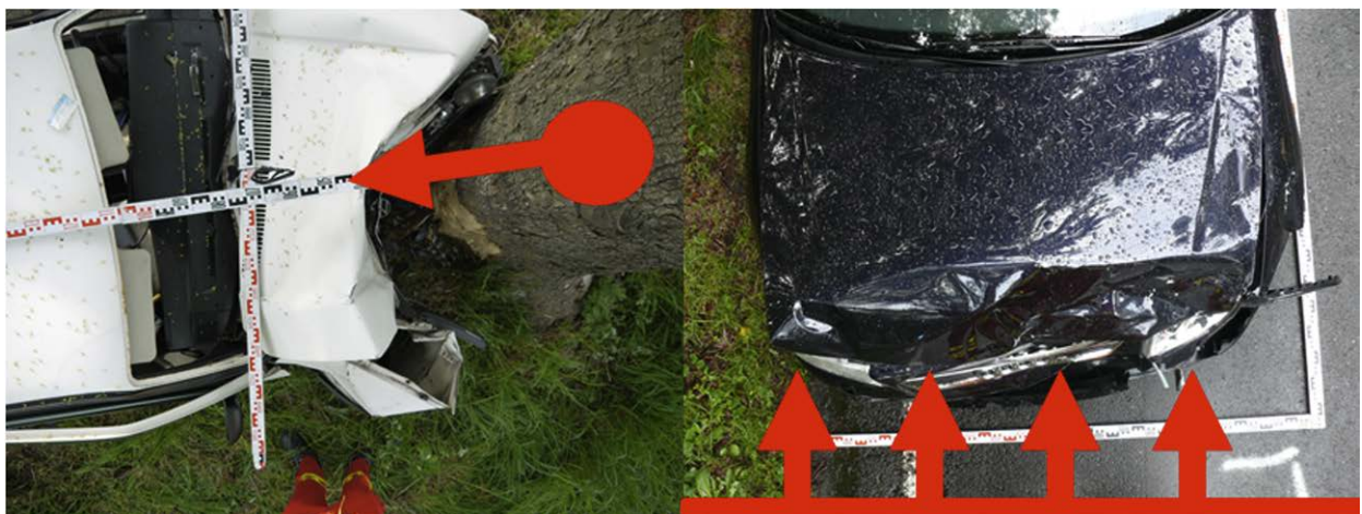
Abbildung 6: Beispiele für die Art der Krafteinleitung (links: Baum, rechts: Schutzplanke) auf die Fahrzeugkarosserie 34
