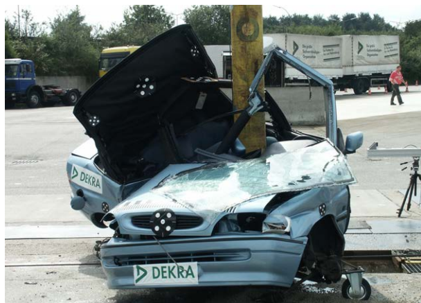
Abbildung 6: Seitlicher Pfahlanprall eines Cabrios (vK = 86 km/h) Foto: DEKRA
