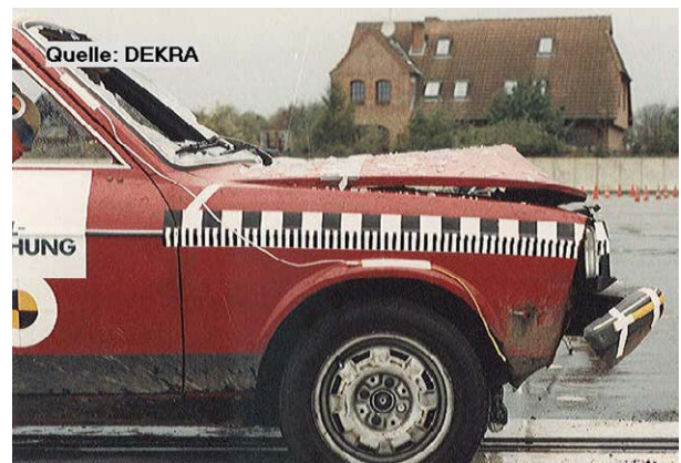
Abbildung 2: Seitliche Ansicht (vK = 17 km/h) Foto: DEKRA
