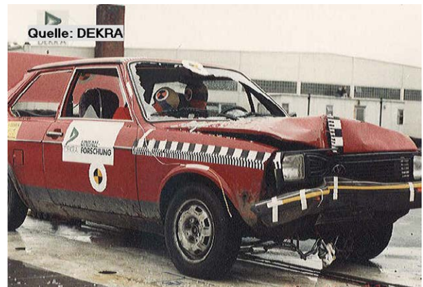
Abbildung 1: Diagonale Ansicht (vK = 17 km/h) Foto: DEKRA
