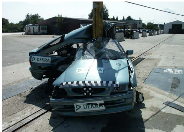
Abbildung 5: Seitlicher Pfahlanprall einer Limousine (vK = 85 km/h) Foto: DEKRA
