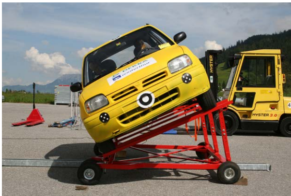
Abbildung 7: Schlitten für Überschlagsversuche Foto: DEKRA / AXA Versicherungen AG
