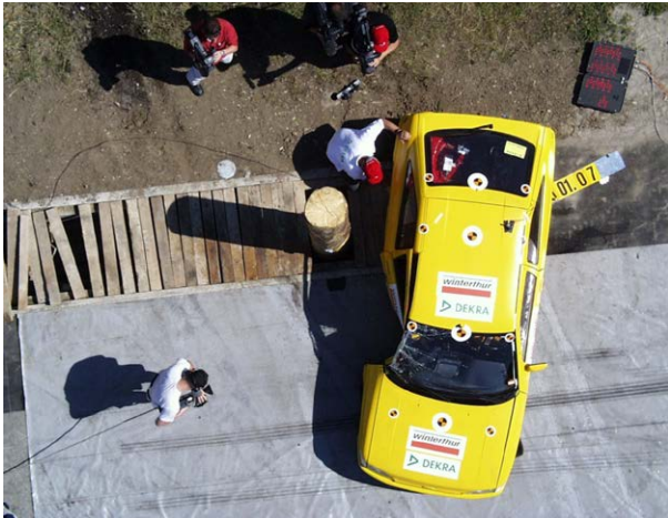
Abbildung 3: Seitlicher Anprall gegen einen Baum (vK = 40 km/h) Foto: DEKRA / AXA Versicherungen AG
