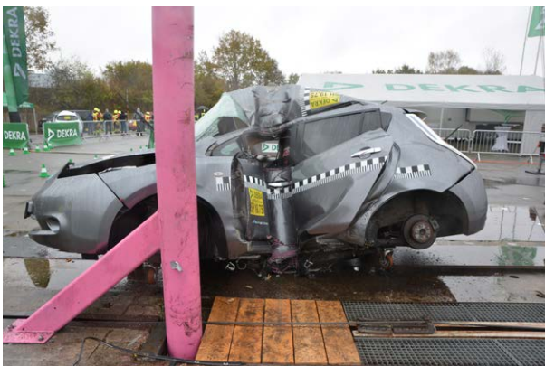
Abbildung 12: Seitlicher Pfahlanprall mit einem Nissan Leaf (vK = 75 km/h) Foto: DEKRA
