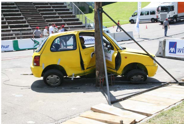
Abbildung 9: Crash mit Überschlag: Erstkontakt mit der Fahrzeugseite (vK = 40 km/h) Foto: DEKRA / AXA Versicherungen AG
